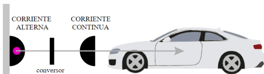
Ilustración 25. Modo 4 de recarga de vehículos eléctricos [7]
