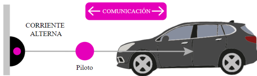
Ilustración 23. Modo 2 de recarga de vehículos eléctricos [7]
