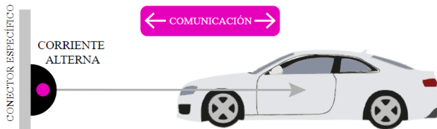
Ilustración 24. Modo 3 de recarga de vehículos eléctricos [7]
