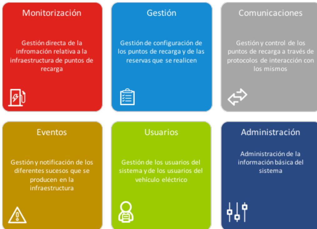
Figura 24: Subsistemas del EV Smart Controller
